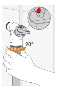
Girando la manilla del tubo 90°, éste queda bloqueado en la válvula. La válvula sólo se puede abrir cuando la manilla se halla en esta posición.
