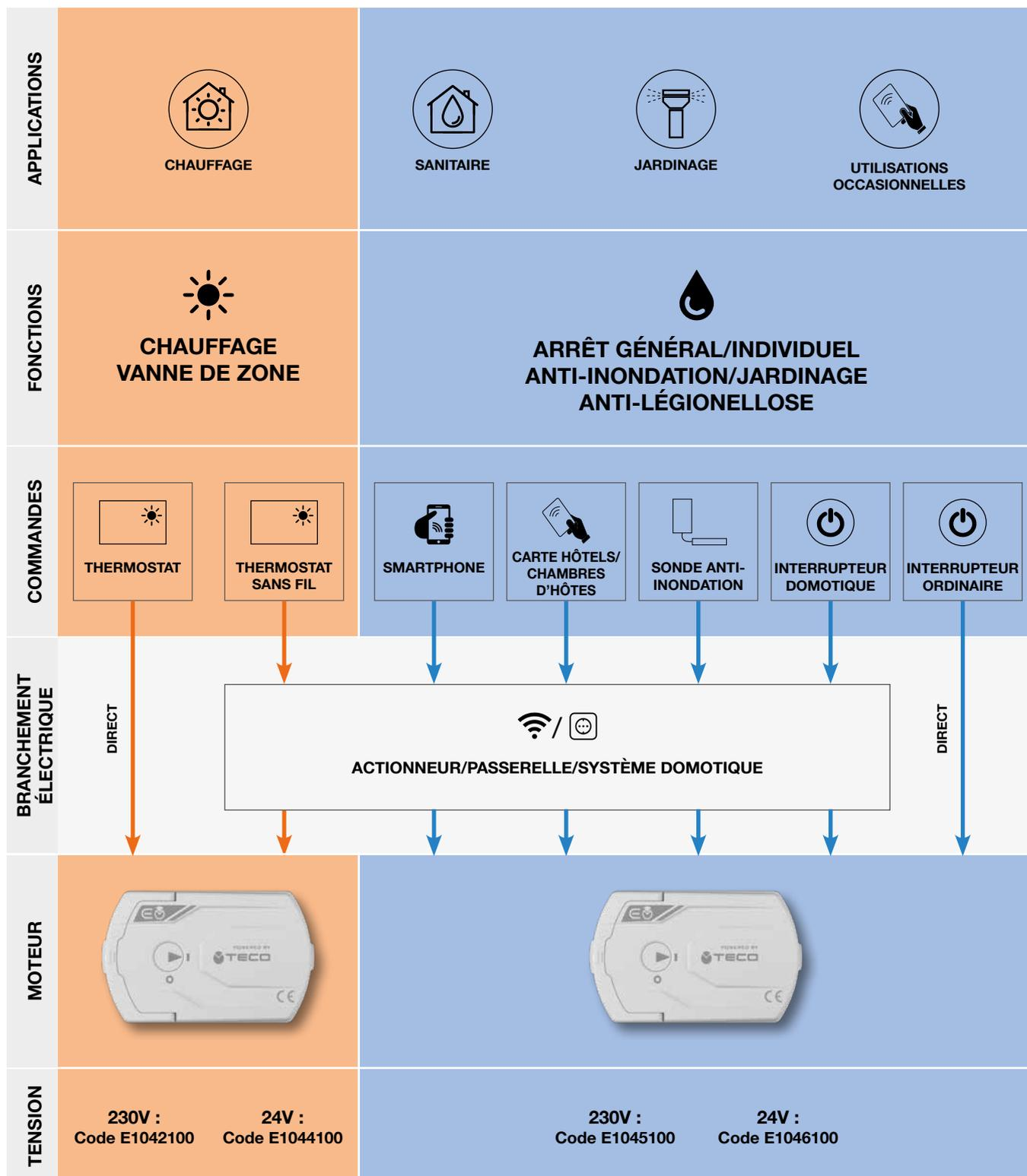
Moteur MARCHÉ/ARRÊT avec micro-interrupteur auxiliaire pour gérer l'activation du générateur avec la vanne ouverte.
